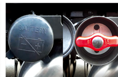
배터리 컷오프 스위치 장기 주차 시 배터리 방전 방지 및 편의성 증대
